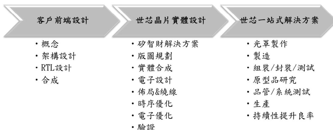
世芯電子除了提供後端設計服務，也提供客戶從設計到晶圓製造、封裝及測試的一站式(Turn-Key)完整服務。在世芯電子的服務流程，晶圓製造階段是從將 GDS II 的檔案交付給晶圓廠製造開始算起，從 GDS II 之交付到晶片成品測試完成，大約費時八到十二周不等。晶片製造過程可概分為晶圓處理製程(Wafer Fabrication; 簡稱 Wafer Fab)、晶圓針測製程(Wafer Probe)、封裝(Assembling)、測試製程(Initial Test and Final Test)等幾個步驟。世芯電子與整體後端設計生產的供應商，皆有緊密的合作關係。
